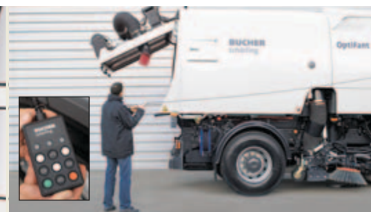
Contenitore rifiuti telecomandato
